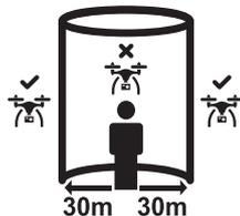
È necessario tenere il drone ad almeno 30 metri di distanza da altre persone.
