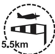
In prossimità di aeroporti minori senza torri di controllo, è consentito operare il drone entro 5,5 km. In presenza di aerei con equipaggio nelle vicinanze, allontanarsi e far atterrare il drone in modo rapido e sicuro.
