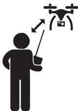
Mantenere il drone entro la propria visuale. Ciò significa che bisogna essere sempre in grado di vedere il drone con i propri occhi (non attraverso un dispositivo, uno schermo o degli occhiali). Non operare il drone in mezzo a nuvole, nebbia o fumo.
