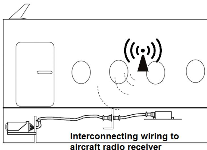
**Figure 4: Back door coupling**
